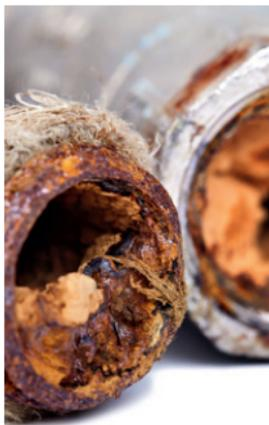
Wasser mit hoher Karbonat- oder Permannenthärte kann zu Kalk- und Gipsablagerungen führen.
